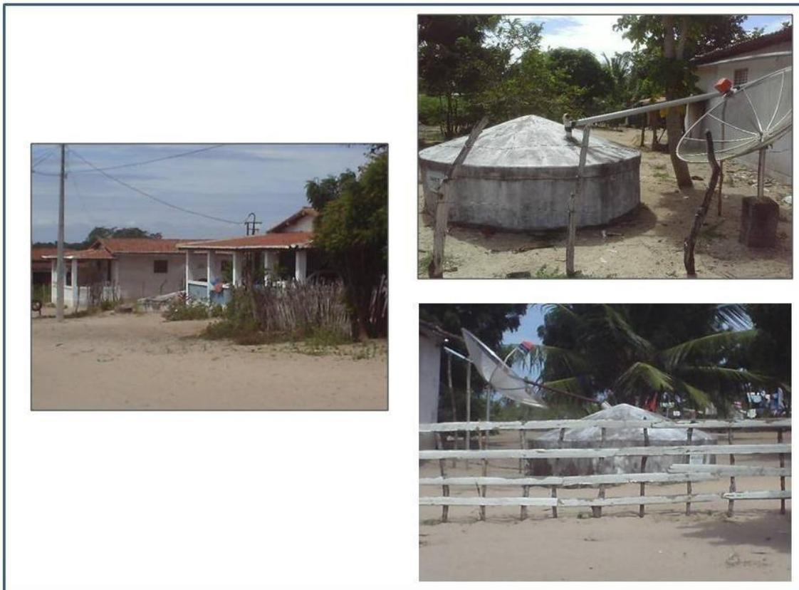
**Figura 0.9** - Cisternas para captação da água de chuva.
